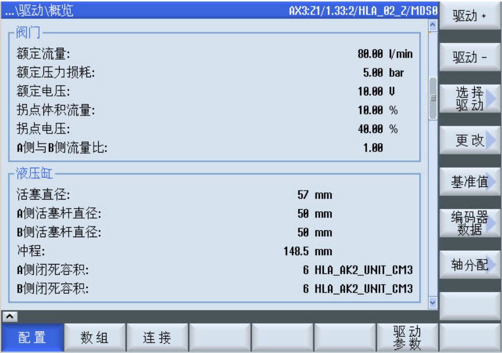
图 4-16 阀门/液压缸一览
